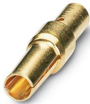
Contact à sertir, Connecteur femelle, tournés, diamètre de contact: 2 mm, zone de sertissage: 0,5 mm<sup>2</sup> ... 0,75 mm<sup>2</sup>, Produit de remplacement selon RoHS II sans exception 6c (Pb < 0,1 %) référence : 1241633
