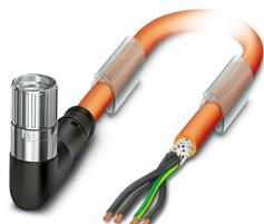
Connecteur de câble à enrobage plastique par extrusion, série: KSF, M23-Connecteur femelle, coudé, rotatif, -120° à gauche / 120° à droite, nombre de pôles: 5+PE, Type de verrouillage: Verrouillage à vis, longueur de câble: 5 m, blindé: oui, coloris de la gaine extérieure: orange RAL 2003, Produit de remplacement selon RoHS II sans exception 6c (Pb < 0,1 %) référence : 1244220
