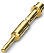
Contact à sertir, Mâle, tournés, Contact unique, diamètre de contact: 1 mm, zone de sertissage: 0,06 mm<sup>2</sup> ... 0,25 mm<sup>2</sup>, Produit de remplacement selon RoHS II sans exception 6c (Pb < 0,1 %) référence : 1243215
