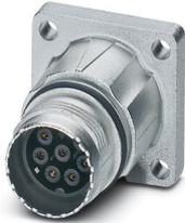
Embases paroi avant, droit, Pour verrouillage standard et SPEEDCON, M17, nombre de pôles: 5+3+PE, type de contact: Mâle, Joint torique axial, 4x Ø 3,2, blindé: oui, cote de bride: 25,75 mm x 25,75 mm, indice de protection: IP67, nombre de pôles: 9, type de raccordement: Raccordement à sertir, série: ST
