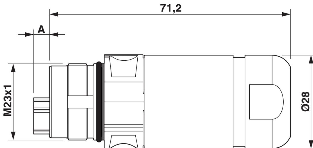
Type de connecteur mâle : dimension A = 4,7 mm, type de connecteur femelle : dimension A = 0 mm
