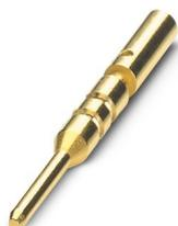
Contact à sertir, Mâle, tournés, diamètre de contact: 0,8 mm, zone de sertissage: 0,08 mm<sup>2</sup> ... 0,25 mm<sup>2</sup>, Produit de remplacement selon RoHS II sans exception 6c (Pb < 0,1 %) référence : 1244458
