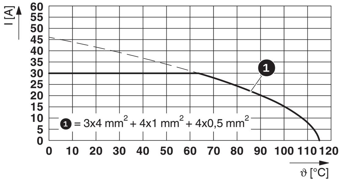
$I$  = intensité,  $\vartheta$  = température ambiante, contacts de puissance A-C : 3 x jusqu'à 30 A, contacts de signalisation : 4 x 2 A stables, contacts de données : 4 x 1 A stables
