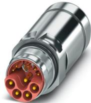
M23, Connecteur prolongateur, série: SH, droit, long, blindé: oui, Pour verrouillage standard et SPEEDCON, Nombre de pôles: 4+4+4+PE / 3+N+PE, Sens de rotation: standard, type de contact: Mâle, Raccordement à sertir, plage de diamètre de câble: 7,5 mm ... 18 mm, détrompage: N, Produit de remplacement selon RoHS II sans exception 6c (Pb < 0,1 %) référence : 1244445
