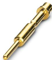
Contact à sertir, Mâle, tournés, diamètre de contact: 1 mm, zone de sertissage: 0,06 mm<sup>2</sup> ... 1 mm<sup>2</sup>, L'article est sans plomb, conformément à la directive RoHS II, sans exception 6c (Pb < 0,1 %)
