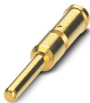
Contact à sertir, Mâle, tournés, diamètre de contact: 2 mm, zone de sertissage: 1,5 mm<sup>2</sup> ... 4 mm<sup>2</sup>, L'article est sans plomb, conformément à la directive RoHS II, sans exception 6c (Pb < 0,1 %)
