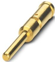
Contact à sertir, Mâle, tournés, diamètre de contact: 2 mm, zone de sertissage: 1,5 mm<sup>2</sup> ... 2,5 mm<sup>2</sup>, Produit de remplacement selon RoHS II sans exception 6c (Pb < 0,1 %) référence : 1244464
