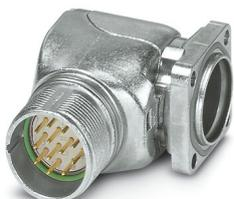
M23, Embases paroi avant, série: RC, coudé rotatif, blindé: oui, Pour verrouillage standard et SPEEDCON, Nombre de pôles: 12, Sens de rotation: standard, type de contact: Mâle, Raccordement à sertir, Joint torique axial, 4x Ø 3,2, détrompage: N
