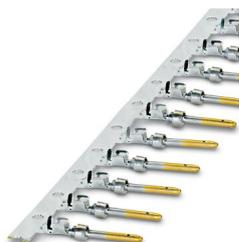
Contact à sertir, Mâle, roulés, Produits en bande, nombre de pièces par bande: 500, diamètre de contact: 1 mm, zone de sertissage: 0,22 mm<sup>2</sup> ... 0,56 mm<sup>2</sup>, L'article est sans plomb, conformément à la directive RoHS II, sans exception 6c (Pb < 0,1 %)
