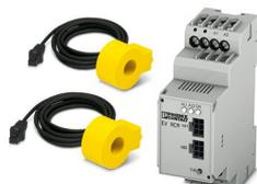
Le module à courant résiduel différentiel sert à détecter un courant de défaut AC et DC dans les points de recharge à courant alternatif. Le dispositif de protection superposé (p. ex. disjoncteur Fi) est protégé des éventuels courants de défaut DC. Il existe une variante du produit à 1 ou 2 canaux.
