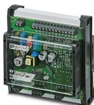
L'automate de charge EV-CC-AC1-M3-CC-SER-HS avec boîtier pour le montage sur profilé, sert à la recharge des véhicules électriques sur le réseau à courant alternatif triphasé selon la norme CEI 61851-1, Mode 3. Optimisé pour les stations de recharge avec un connecteur de charge pour véhicule, monté en fixe. Toutes les fonctions de recharge et de vastes réglages de configuration sont déjà intégrés.
