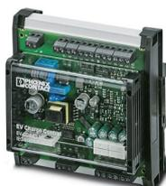
L'automate de charge EV-CC-AC1-M3-CBC-SER-HS avec boîtier pour le montage sur profilé sert à la recharge des véhicules électriques sur le réseau à courant alternatif triphasé selon la norme CEI 61851-1, Mode 3. Toutes les fonctions de recharge, de vastes réglages de configuration ainsi qu'une commande de verrouillage sont déjà intégrés.
