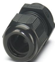
Presse-étoupe, matériau du raccordement vissé: PA, diamètre extérieur du câble 6 mm ... 12 mm, blindage: non, filetage de raccordement: M20 x 1,5, coloris: noir foncé RAL 9005
