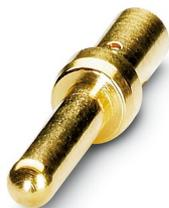
Contact à sertir, Mâle, tournés, diamètre de contact: 1 mm, zone de sertissage: 0,14 mm<sup>2</sup> ... 0,56 mm<sup>2</sup>, Produit de remplacement selon RoHS II sans exception 6c (Pb < 0,1 %) référence : 1244901
