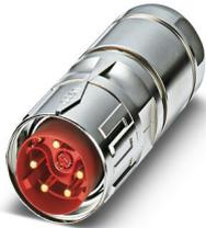
M40, Connecteurs à câble, série: SB, droit, long, blindé: oui, SPEEDCONNEC, Nombre de pôles: 4+4+4+PE / 3+N+PE, Sens de rotation: standard, type de contact: Mâle, Raccordement à sertir, plage de diamètre de câble: 14 mm ... 20,5 mm, détrompage: CAT5, détrompage 1, Produit de remplacement selon RoHS II sans exception 6c (Pb < 0,1 %) référence : 1244862
