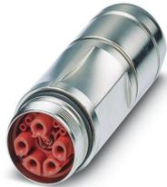
M40, Connecteur prolongateur, série: SB, droit, long, blindé: oui, Pour verrouillage standard et SPEEDCON, Nombre de pôles: 4+4+4+PE / 3+N+PE, Sens de rotation: standard, type de contact: Connecteur femelle, Raccordement à sertir, plage de diamètre de câble: 14 mm ... 20,5 mm, détrompage: CAT5, détrompage 1, Produit de remplacement selon RoHS II sans exception 6c (Pb < 0,1 %) référence : 1244869
