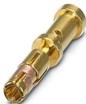
Contact à sertir, Connecteur femelle, tournés, diamètre de contact: 1 mm, zone de sertissage: 0,5 mm<sup>2</sup> ... 1 mm<sup>2</sup>, Produit de remplacement selon RoHS II sans exception 6c (Pb < 0,1 %) référence : 1244919
