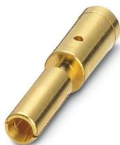
Contact à sertir, Connecteur femelle, tournés, diamètre de contact: 1 mm, zone de sertissage: 1 mm<sup>2</sup> ... 1,5 mm<sup>2</sup>, Produit de remplacement selon RoHS II sans exception 6c (Pb < 0,1 %) référence : 1244920
