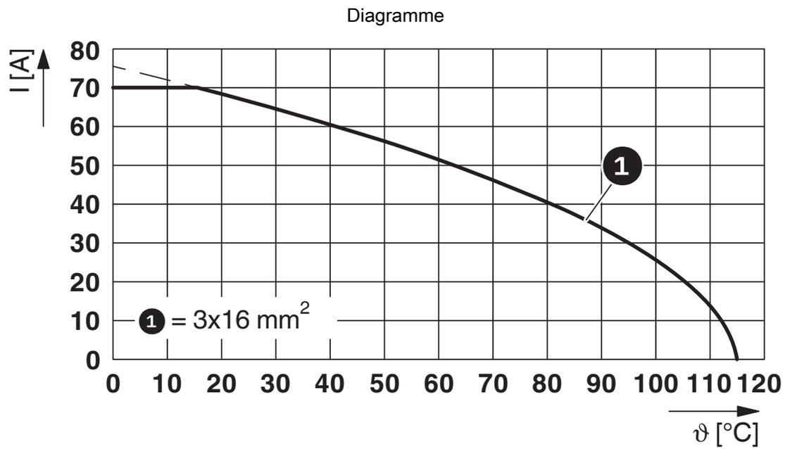
$I$  = intensité,  $\vartheta$  = température ambiante, contacts de puissance A-C : 3x jusqu'à 70 A, contacts de signalisation : 4x 2 A stables, contacts de données : non chargés
