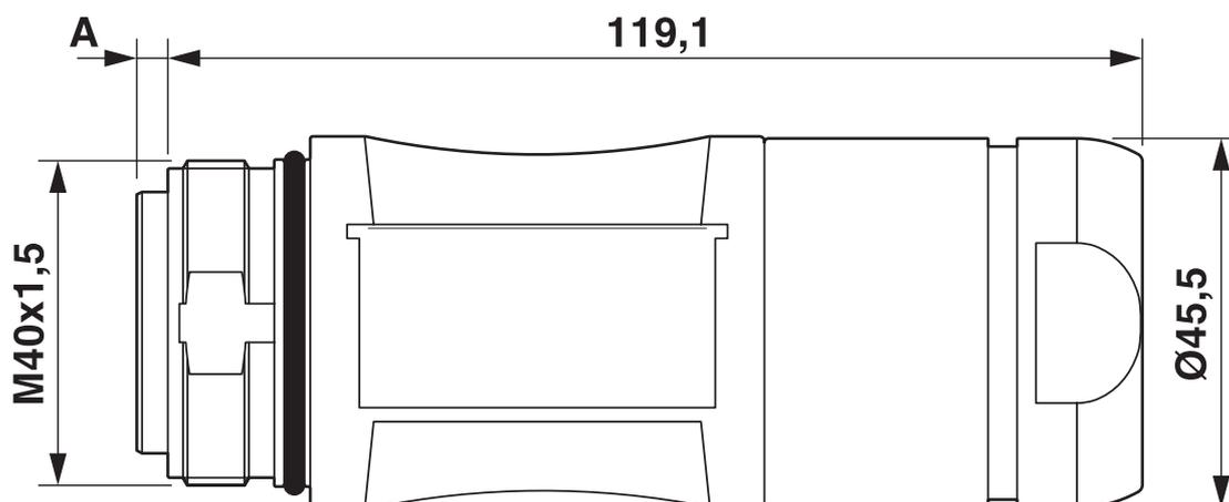
Type de connecteur mâle : dimension A = 3,8 mm, type de connecteur femelle : dimension A = 0,15 mm
