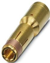
Contact à sertir, Connecteur femelle, tournés, Contact unique, diamètre de contact: 3,6 mm, zone de sertissage: 10 mm<sup>2</sup> ... 10 mm<sup>2</sup>, Produit de remplacement selon RoHS II sans exception 6c (Pb < 0,1 %) référence : 1244891
