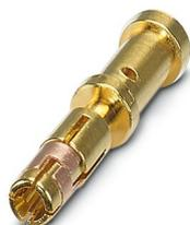
Contact à sertir, Connecteur femelle, tournés, diamètre de contact: 1 mm, zone de sertissage: 0,34 mm<sup>2</sup> ... 0,5 mm<sup>2</sup>, Produit de remplacement selon RoHS II sans exception 6c (Pb < 0,1 %) référence : 1244919
