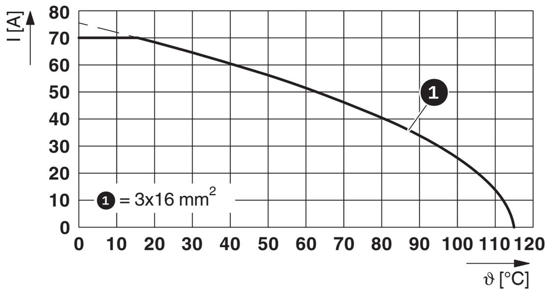
$I$  = intensité,  $\vartheta$  = température ambiante, contacts de puissance A-C : 3x jusqu'à 70 A, contacts de signalisation : 4x 2 A stables, contacts de données : non chargés
