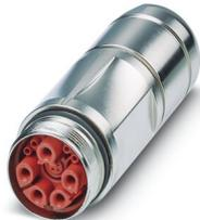
M40, Connecteur prolongateur, série: SB, droit, long, blindé: oui, Pour verrouillage standard et SPEEDCON, Nombre de pôles: 8+4+PE, Sens de rotation: standard, type de contact: Connecteur femelle, Raccordement à sertir, plage de diamètre de câble: 14 mm ... 20,5 mm, détrompage: Signal, détrompage 1, Produit de remplacement selon RoHS II sans exception 6c (Pb < 0,1 %) référence : 1244873
