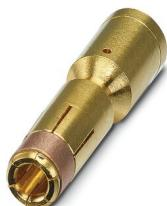
Contact à sertir, Connecteur femelle, tournés, Contact unique, diamètre de contact: 3,6 mm, zone de sertissage: 10 mm<sup>2</sup> ... 10 mm<sup>2</sup>, Produit de remplacement selon RoHS II sans exception 6c (Pb < 0,1 %) référence : 1244891
