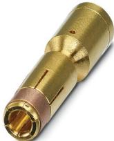
Contact à sertir, Connecteur femelle, tournés, Contact unique, diamètre de contact: 3,6 mm, zone de sertissage: 16 mm<sup>2</sup> ... 16 mm<sup>2</sup>, Produit de remplacement selon RoHS II sans exception 6c (Pb < 0,1 %) référence : 1244892
