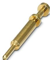
Contact à sertir, Mâle, tournés, diamètre de contact: 1 mm, zone de sertissage: 0,34 mm<sup>2</sup> ... 0,5 mm<sup>2</sup>
