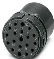
Élément de contact, M23, nombre de pôles: 16+2+FE, type de contact: Mâle, Raccordement à sertir
