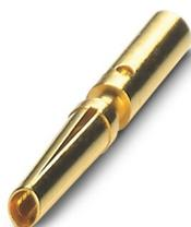
Contact à sertir, Connecteur femelle, tournés, diamètre de contact: 0,8 mm, zone de sertissage: 0,08 mm<sup>2</sup> ... 0,25 mm<sup>2</sup>, Produit de remplacement selon RoHS II sans exception 6c (Pb < 0,1 %) référence : 1244455
