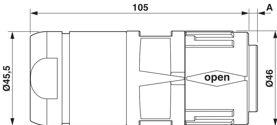
Type de connecteur mâle : dimension A = 4,05 mm, type de connecteur femelle : dimension A = 0,4 mm
