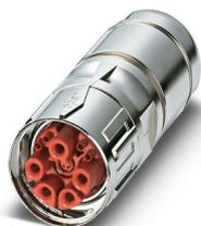
M40, Connecteurs à câble, série: SB, droit, long, blindé: oui, SPEEDCONNEC, Nombre de pôles: 4+4+4+PE / 3+N+PE, Sens de rotation: standard, type de contact: Connecteur femelle, Raccordement à sertir, plage de diamètre de câble: 20,5 mm ... 26,5 mm, détrompage: CAT5, détrompage 2, Produit de remplacement selon RoHS II sans exception 6c (Pb < 0,1 %) référence : 1244939
