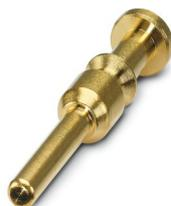
Contact à sertir, Mâle, tournés, diamètre de contact: 3,6 mm, zone de sertissage: 2,5 mm<sup>2</sup> ... 4 mm<sup>2</sup>, Produit de remplacement selon RoHS II sans exception 6c (Pb < 0,1 %) référence : 1244894
