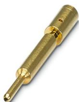
Contact à sertir, Mâle, tournés, Contact unique, diamètre de contact: 1 mm, zone de sertissage: 1 mm<sup>2</sup> ... 1,5 mm<sup>2</sup>, Produit de remplacement selon RoHS II sans exception 6c (Pb < 0,1 %) référence : 1244925
