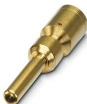
Contact à sertir, Mâle, tournés, Contact unique, diamètre de contact: 3,6 mm, zone de sertissage: 16 mm<sup>2</sup> ... 16 mm<sup>2</sup>, Produit de remplacement selon RoHS II sans exception 6c (Pb < 0,1 %) référence : 1244896
