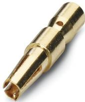
Contact à sertir, Connecteur femelle, tournés, diamètre de contact: 1,5 mm, zone de sertissage: 0,5 mm<sup>2</sup> ... 1 mm<sup>2</sup>, Produit de remplacement selon RoHS II sans exception 6c (Pb < 0,1 %) référence : 1244969
