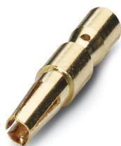
Contact à sertir, Connecteur femelle, tournés, diamètre de contact: 1,5 mm, zone de sertissage: 0,08 mm<sup>2</sup> ... 0,22 mm<sup>2</sup>, Produit de remplacement selon RoHS II sans exception 6c (Pb < 0,1 %) référence : 1245474
