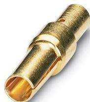
Contact à sertir, Connecteur femelle, tournés, Contact unique, diamètre de contact: 1 mm, zone de sertissage: 0,14 mm<sup>2</sup> ... 0,56 mm<sup>2</sup>, Produit de remplacement selon RoHS II sans exception 6c (Pb < 0,1 %) référence : 1241093
