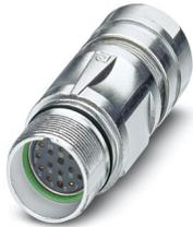
M23, Connecteur prolongateur, série: CA, droit, blindé: oui, Pour verrouillage standard et SPEEDCON, Nombre de pôles: 16+2+FE, Sens de rotation: standard, type de contact: Connecteur femelle, Raccordement à sertir, plage de diamètre de câble: 10 mm ... 14,5 mm, détrompage: N, Produit de remplacement selon RoHS II sans exception 6c (Pb < 0,1 %) référence : 1245042
