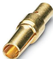
Contact à sertir, Connecteur femelle, tournés, Contact unique, diamètre de contact: 1 mm, zone de sertissage: 0,5 mm<sup>2</sup> ... 1 mm<sup>2</sup>, Produit de remplacement selon RoHS II sans exception 6c (Pb < 0,1 %) référence : 1241572
