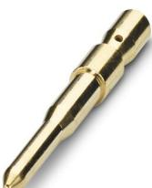
Contact à sertir, Mâle, tournés, diamètre de contact: 1,5 mm, zone de sertissage: 0,14 mm<sup>2</sup> ... 0,56 mm<sup>2</sup>, Produit de remplacement selon RoHS II sans exception 6c (Pb < 0,1 %) référence : 1245475
