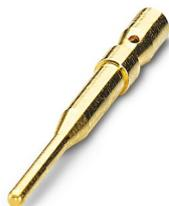
Contact à sertir, Mâle, tournés, diamètre de contact: 1 mm, zone de sertissage: 0,14 mm<sup>2</sup> ... 0,56 mm<sup>2</sup>, Produit de remplacement selon RoHS II sans exception 6c (Pb < 0,1 %) référence : 1244971
