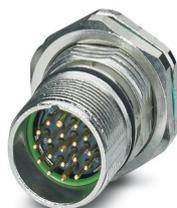
M23, Connecteur d'appareil face arrière, série: CA, droit, blindé: oui, Pour verrouillage standard et SPEEDCON, Nombre de pôles: 16+2+FE, Sens de rotation: standard, type de contact: Mâle, Raccordement à sertir, Joint axial, Fixation centrale, détrompage: N, Produit de remplacement selon RoHS II sans exception 6c (Pb < 0,1 %) référence : 1245049
