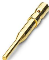
Contact à sertir, Mâle, tournés, diamètre de contact: 1 mm, zone de sertissage: 0,5 mm<sup>2</sup> ... 1 mm<sup>2</sup>, Produit de remplacement selon RoHS II sans exception 6c (Pb < 0,1 %) référence : 1244972
