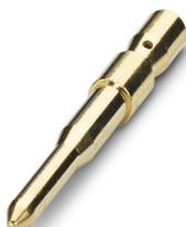
Contact à sertir, Mâle, tournés, diamètre de contact: 1,5 mm, zone de sertissage: 0,08 mm<sup>2</sup> ... 0,22 mm<sup>2</sup>, Produit de remplacement selon RoHS II sans exception 6c (Pb < 0,1 %) référence : 1245475
