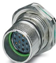
M23, Connecteur d'appareil face arrière, série: CA, droit, blindé: oui, Pour verrouillage standard et SPEEDCON, Nombre de pôles: 16+2+FE, Sens de rotation: standard, type de contact: Connecteur femelle, Raccordement à sertir, Joint axial, Fixation centrale, détrompage: N, Produit de remplacement selon RoHS II sans exception 6c (Pb < 0,1 %) référence : 1245050
