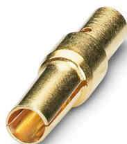
Contact à sertir, Connecteur femelle, tournés, Contact unique, diamètre de contact: 1 mm, zone de sertissage: 0,14 mm<sup>2</sup> ... 0,56 mm<sup>2</sup>, Produit de remplacement selon RoHS II sans exception 6c (Pb < 0,1 %) référence : 1241093
