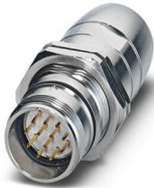
M23, Traversée face arrière, série: UC, droit, blindé: oui, Verrouillage à vis, Nombre de pôles: 17, Sens de rotation: standard, type de contact: Mâle, Raccordement à sertir, Joint torique axial, Fixation centrale, plage de diamètre de câble: 6,5 mm ... 14,5 mm, détrompage: N, Produit de remplacement selon RoHS II sans exception 6c (Pb < 0,1 %) référence : 1245322
