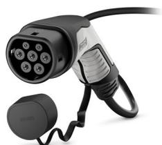
CHARX connect comfort, Câble de charge AC, avec connecteur de charge côté véhicule et extrémité de câble libre, pour charger en courant alternatif (AC) des véhicules électriques (EV) à prise côté véhicule de type 2, avec cache de protection, Type 2, CEI 62196-2, 32 A / 480 V (AC), boîtiers: noir, gris, Logo PHOENIX CONTACT, câble: 5 m, noir, droit
