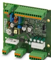
L'automate de charge EV-CC-AC1-M3-CBC-SER-PCB-MSTB sous forme de circuit imprimé sert à la recharge des véhicules électriques selon la norme CEI 61851-1, Mode 3, cas B (sortie de prise) ou C (connecteur de charge du véhicule). Raccordement via un connecteur mâle pour C.I. sur l'embase.
