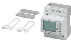
Compteur électrique triphasé pour la détermination par mesure directe de la puissance active dans des réseaux pouvant atteindre 500 V / 80 A, avec sortie S0, entrée TOR et interface RS-485, certifié selon la directive MID
