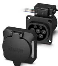
CHARX connect modular, Prise côté infrastructure, Rectangulaire, Premium, Kit, avec capot de protection carré, avec capteurs de température, avec LED (raccord de cathode commun), pour la charge en courant alternatif (AC) des véhicules électriques (VE), Type 2, CEI 62196-2, 32 A / 480 V (AC), sans fils individuels, actionneur de verrouillage: 12 V, 4 pôles, Montage sur la paroi arrière, Filetage M5, boîtiers: noir, Logo PHOENIX CONTACT
