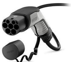
CHARX connect comfort, Câble de charge AC, avec connecteur de charge côté infrastructure et extrémité de câble libre, pour la charge en courant alternatif (AC) des véhicules électriques (VE), avec cache de protection, Type 2, CEI 62196-2, 32 A / 250 V (AC), boîtiers: noir, gris, Logo PHOENIX CONTACT, câble: 1,5 m, noir, droit
