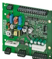
L'automate de charge EV-CC-AC1-M3-CBC-SER-PCB sous forme de circuit imprimé sert à la recharge des véhicules électriques sur le réseau à courant alternatif triphasé selon la norme CEI 61851-1, Mode 3. Toutes les fonctions de recharge, de vastes réglages de configuration ainsi qu'une commande de verrouillage sont déjà intégrés.
