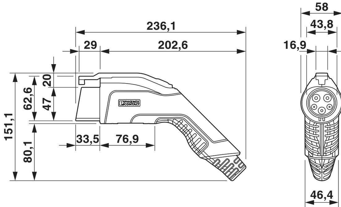
S'assurer que le connecteur de charge côté véhicule est enfiché pendant toute la durée de l'arrêt du chargement dans un support de connecteur de charge adapté, qui assure une protection minimale IP24 selon la norme CEI 61851-1. Pour fabriquer un tel support de connecteur de charge, utilisez les dimensions du connecteur de charge côté véhicule. Vous trouverez également des dimensions détaillées dans la zone des téléchargements.
