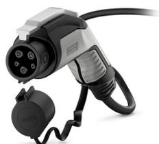
CHARX connect comfort, Câble de charge AC, avec connecteur de charge côté véhicule et extrémité de câble libre, pour charger en courant alternatif (AC) des véhicules électriques (EV) à prise côté véhicule de type 1, avec cache de protection, Type 1, SAE J1772, 32 A / 250 V (AC), Logo PHOENIX CONTACT, câble: 5 m, noir, droit
