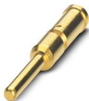
Contact à sertir, Mâle, tournés, Contact unique, diamètre de contact: 2 mm, zone de sertissage: 1,5 mm<sup>2</sup> ... 2,5 mm<sup>2</sup>, Produit de remplacement selon RoHS II sans exception 6c (Pb < 0,1 %) référence : 1238179
