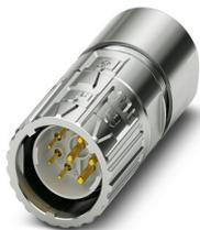
M23, Connecteurs à câble, série: M23 PRO, droit, court, blindé: oui, Verrouillage rapide ONECLICK, Nombre de pôles: 4+3+PE, type de contact: Mâle, Raccordement à sertir, plage de diamètre de câble: 7,5 mm ... 12 mm, L'article est sans plomb, conformément à la directive RoHS II, sans exception 6c (Pb < 0,1 %)
