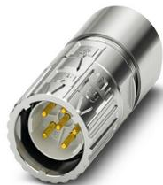
M23, Connecteurs à câble, série: M23 PRO, droit, court, blindé: oui, Verrouillage rapide ONECLICK, Nombre de pôles: 5+PE, type de contact: Mâle, Raccordement à sertir, plage de diamètre de câble: 5,5 mm ... 8 mm, L'article est sans plomb, conformément à la directive RoHS II, sans exception 6c (Pb < 0,1 %)
