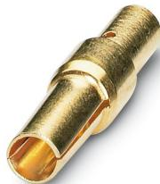
Contact à sertir, Connecteur femelle, tournés, Contact unique, diamètre de contact: 2 mm, zone de sertissage: 0,75 mm<sup>2</sup> ... 1 mm<sup>2</sup>, Produit de remplacement selon RoHS II sans exception 6c (Pb < 0,1 %) référence : 1241633
