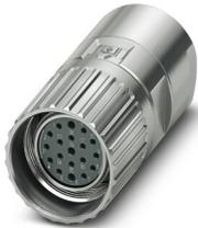
M23, Connecteurs à câble, série: M23 PRO, droit, blindé: oui, Verrouillage à vis, Nombre de pôles: 16+2+PE, Sens de rotation: standard, type de contact: Connecteur femelle, Raccordement à sertir, plage de diamètre de câble: 3 mm ... 15 mm, L'article est sans plomb, conformément à la directive RoHS II, sans exception 6c (Pb < 0,1 %)
