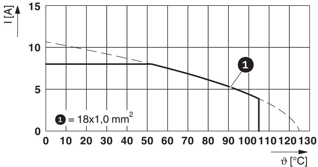
$I$  = intensité,  $\vartheta$  = température ambiante, 18x 8 A
