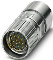
M23, Connecteurs à câble, série: M23 PRO, droit, blindé: oui, Verrouillage à vis, Nombre de pôles: 17, Sens de rotation: standard, type de contact: Mâle, Raccordement à sertir, plage de diamètre de câble: 3 mm ... 15 mm, détrompage: N, L'article est sans plomb, conformément à la directive RoHS II, sans exception 6c (Pb < 0,1 %)
