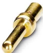
Contact à sertir, Mâle, tournés, Contact unique, diamètre de contact: 1 mm, zone de sertissage: 0,14 mm<sup>2</sup> ... 0,56 mm<sup>2</sup>, Produit de remplacement selon RoHS II sans exception 6c (Pb < 0,1 %) référence : 1240882
