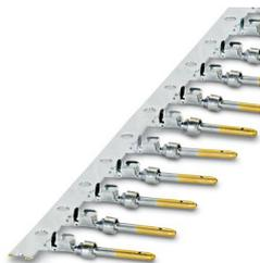
Contact à sertir, Mâle, roulés, Produits en bande, nombre de pièces par bande: 10000, diamètre de contact: 1 mm, zone de sertissage: 0,22 mm<sup>2</sup> ... 0,56 mm<sup>2</sup>, L'article est sans plomb, conformément à la directive RoHS II, sans exception 6c (Pb < 0,1 %)
