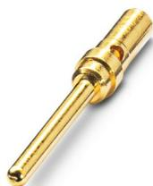
Contact à sertir SUB-D, type de raccordement: Raccordement à sertir, section raccordable: AWG 24- 20
