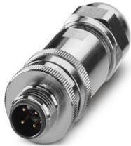
Connecteur, Universel, 4-pôles, blindé, connecteur mâle droit M12, détrompage: A, Raccordement vissé, matériau de la molette: Laiton, nickelé, presse-étoupe Pg7, diamètre extérieur du câble 4 mm ... 6 mm
