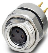
Connecteur d'appareil face arrière, 3-pôles, connecteur femelle, droit, M8, Montage face arrière, M12 x 1, Soudage à la vague
