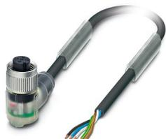
Câble pour capteurs/actionneurs, 5-pôles exempt d'halogène, extrémité libre, sur Connecteur femelle coudé M12, détrompage: A, avec 3 LED, longueur de câble: 10 m
