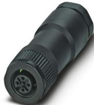
Connecteur, Universel, 5-pôles, connecteur femelle droit M12, détrompage: A, Raccordement vissé, matériau de la molette: Plastique, presse-étoupe Pg11-DUO, diamètre extérieur du câble 2,1 mm ... 3 mm / 4 mm ... 5,2 mm
