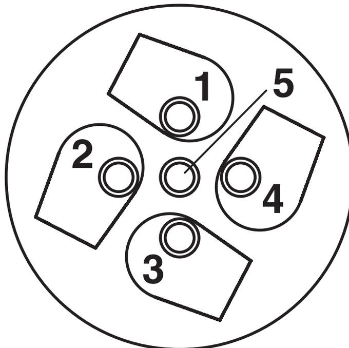
Côté connexion câble M12 (connexion vissée)
