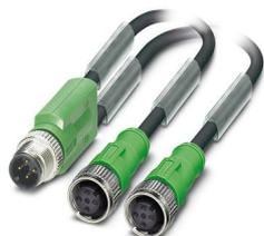
Câble pour capteurs/actionneurs, 4-pôles exempt d'halogène, connecteur mâle droit M12, détrompage: A, sur Connecteur femelle droit M12, détrompage: A, longueur de câble: 1 m
