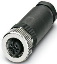
Connecteur, Universel, 4-pôles, connecteur femelle droit M12, détrompage: A, Raccordement vissé, matériau de la molette: Zinc moulé sous pression, nickelé, presse-étoupe Pg9, diamètre extérieur du câble 6 mm ... 8 mm
