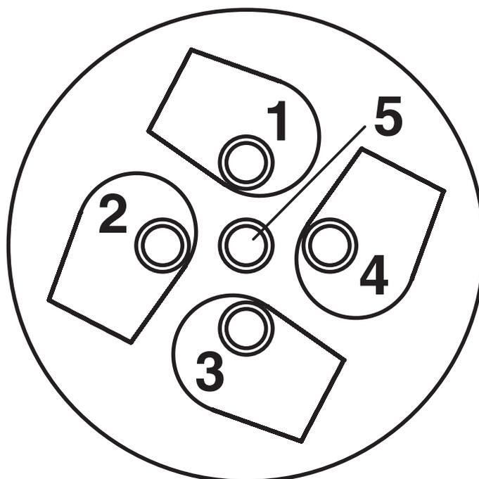
Côté connexion câble M12 (connexion vissée)
