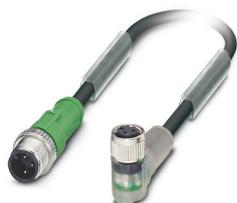
Câble pour capteurs/actionneurs, 3-pôles exempt d'halogène, connecteur mâle droit M12, détrompage: A, avec 2 LED, sur Connecteur femelle coudé M8, avec 2 LED, longueur de câble: 5 m
