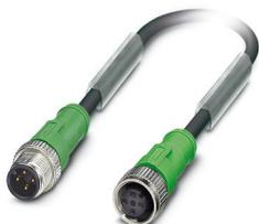
Câble pour capteurs/actionneurs, 4-pôles exempt d'halogène, connecteur mâle droit M12, détrompage: A, sur Connecteur femelle droit M12, détrompage: A, longueur de câble: 1 m
