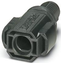
Connecteur photovoltaïque, Famille d'articles: Sunclix, matériau du boîtier: PPE, coloris: noir, nombre de pôles: 1, tension de référence: 1000 V DC, courant de référence: 40 A, Type de raccordement: Sertissage, Type de contact: Mâle
