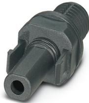
Connecteur photovoltaïque, Famille d'articles: Sunclix, matériau du boîtier: PPE, coloris: noir, nombre de pôles: 1, tension de référence: 1000 V DC, courant de référence: 40 A, Type de raccordement: Sertissage, Type de contact: Connecteur femelle
