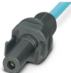
Embases paroi avant, Famille d'articles: Sunclix, matériau du boîtier: PPE, coloris: noir, section de fil min.: 4 mm<sup>2</sup>, Type de raccordement: Sertissage, Type de contact: Connecteur femelle, longueur de câble: 200
