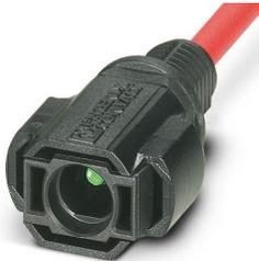
Embases paroi avant, Famille d'articles: Sunclix, matériau du boîtier: PPE, coloris: noir, nombre de pôles: 1, section de fil min.: 2,5 mm<sup>2</sup>, tension de référence: 1000 V DC, courant de référence: 27 A, Type de raccordement: Sertissage, Type de contact: Mâle, longueur de câble: 300
